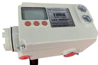
El posicionador eléctrico-neumático serie L8A-100 recibe una señal de corriente CC de 4-20 mA del controlador o del sistema de control, y controla con precisión la apertura de la válvula a través del actuador neumático.
